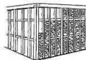
شکل ۹. اجزای دیوار قاب چوبی (Hueto Escobar et al., 2022)
